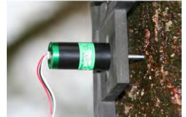
Abbildung 1. Punktendrometer sind hochempfindliche Sensoren, die sowohl wachsende Zellen als auch Veränderungen im Baum-Wasserhaushalt messen.
