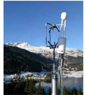
**Abbildung 3.** Das Herzstück der Eddy-Kovarianz-Messung befindet sich auf 35 m.
